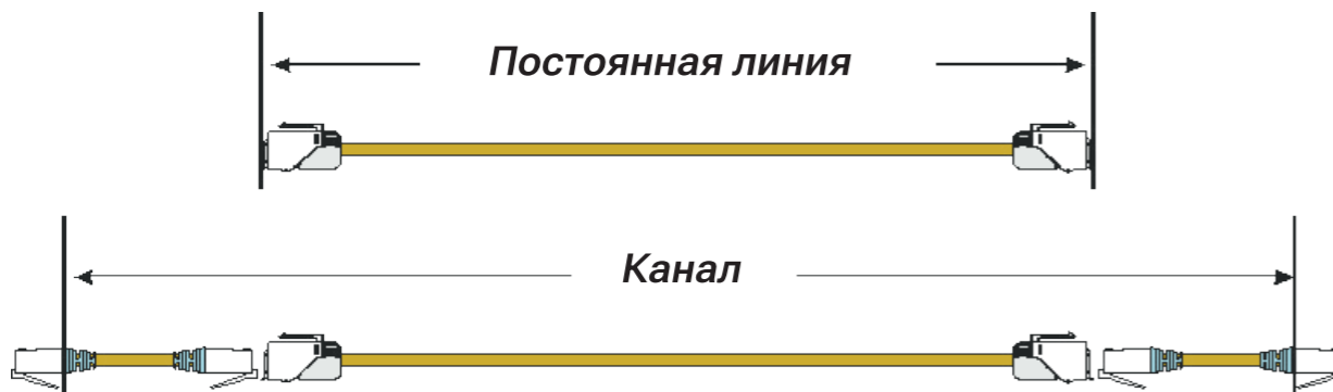
Рис. 3. Постоянная линия (PL) и Канал (CH) горизонтальной подсистемы СКС
